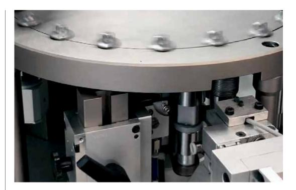
La nuova stazione di controllo per filetti M6 esegue il **controllo elettro-meccanico a 360°** capace di individuare la presenza **bollature in rilevo, trucioli, bave e difetti di rullatura** che causano il disallineamento del filetto (filetto a zeta). Il sistema è idoneo al controllo di una sezione di filetto M6 fino ad un massimo 14 millimetri a partire dalla testa, per pezzi metallici di lunghezza massima sotto-testa di 30 millimetri.
