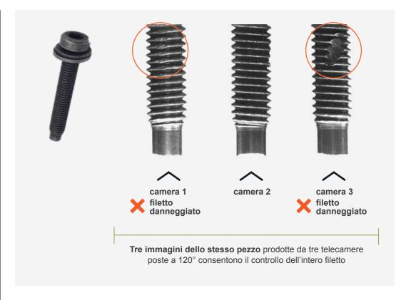
elaborate dal sistema per intercettare eventuali difettosità. Nel caso de La Mille, vengono impiegate tre telecamere intallate sotto il disco rotante, ad un'angolazione reciproca di 120° e fissate su una colonna regolabile che supporta anche un unico illuminatore circolare coassiale al pezzo da controllare.
